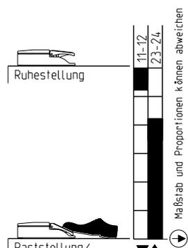
Zum Erreichen der Raststellung muß das Pedal bis zum Anschlag betätigt werden. Zwangsöffnung bei Pedalanschlag.
